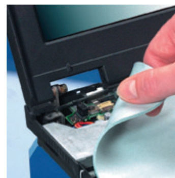
Applikation eines Elastomer-Pads in einem Laptop
